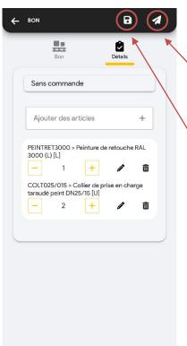
Une fois le BL envoyé, il est visible dans Optim'BTP et devient non modifiable dans l'application mobile (Etat : envoyé)
